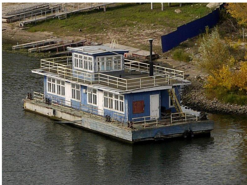
*Рис. 3. Дебаркадер из железобетона [6].*
