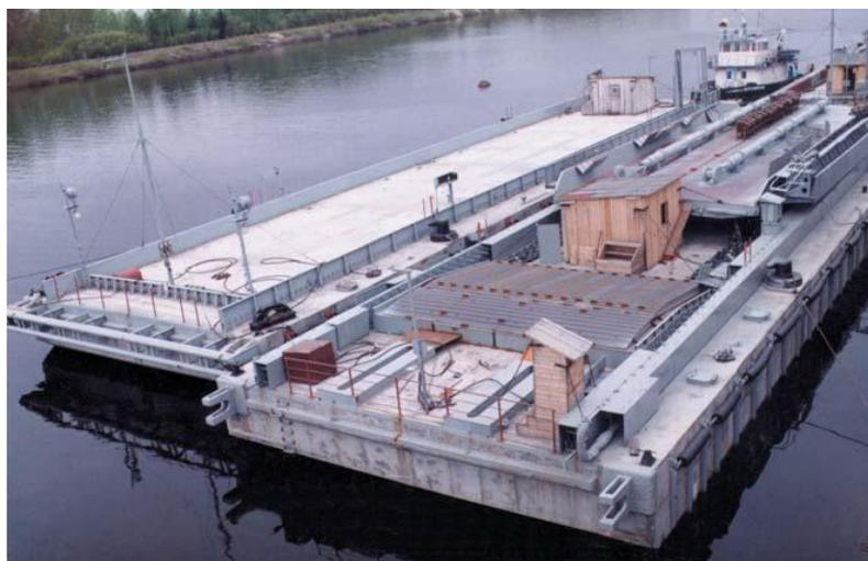
*Рис. 4. Понтоны тяжелого железобетонного причала (проект ЦКБ «Монолит») [3, с. 3].*
